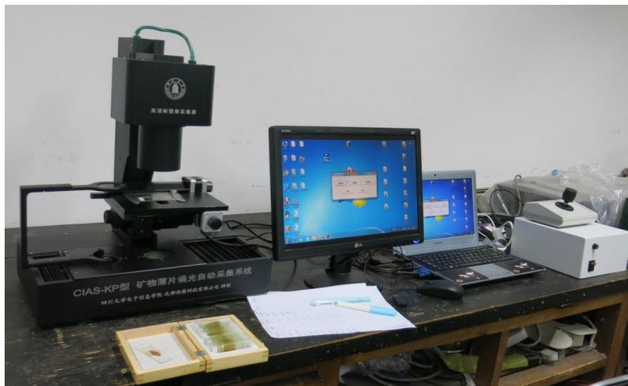
图 5 矿物薄片偏光自动采集系统
